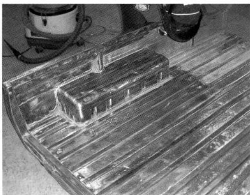
図.4 エアーサンダによる作業
