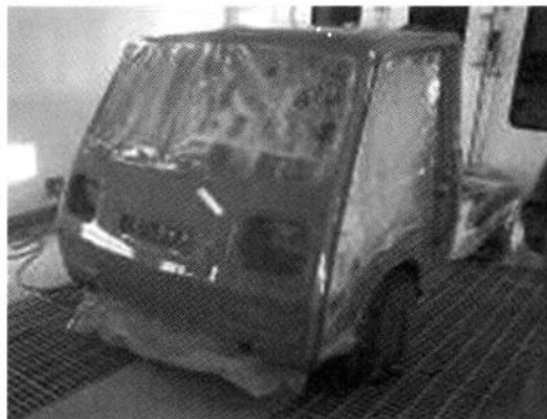
図.11 キャビン部の塗装
