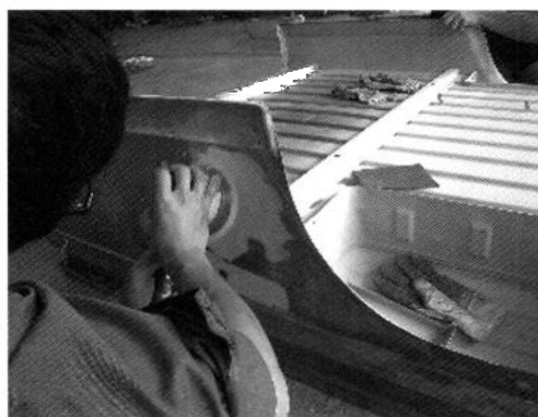
図.5 パテによる面出し
