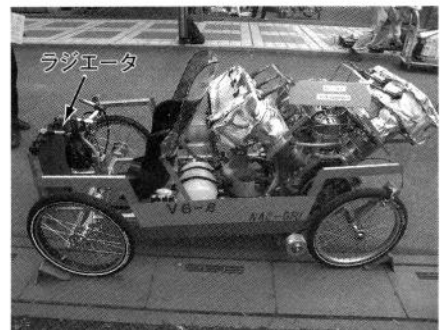
図8 第12回大会 ラジエータを搭載
