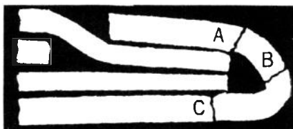
ボアシール部のクラッキング発生箇所
