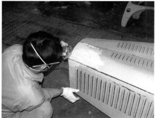
図18 ボンネットのパテ研ぎ
