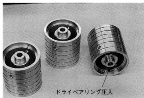
図5 アルマイト処理のパワーピストン
