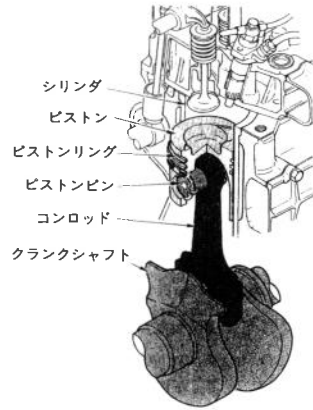
図1 ピストン関係模式図
