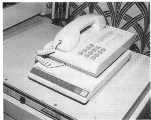
Fig. 4.3 モデム 電話番号メモリ付き電話機の下がモデムである
