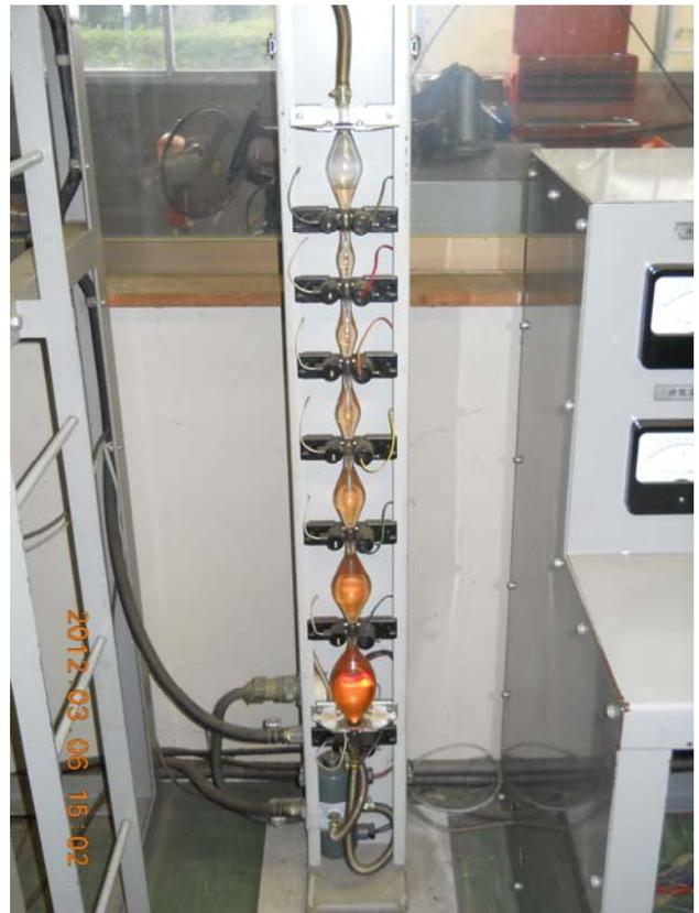
図11. 燃料消費量検出部構造
