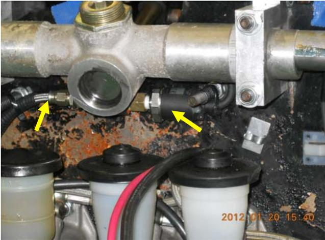
図7. 油圧センサ (ブレーキライン圧)
