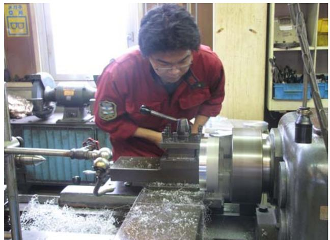
図7. センターボス外径旋盤加工
