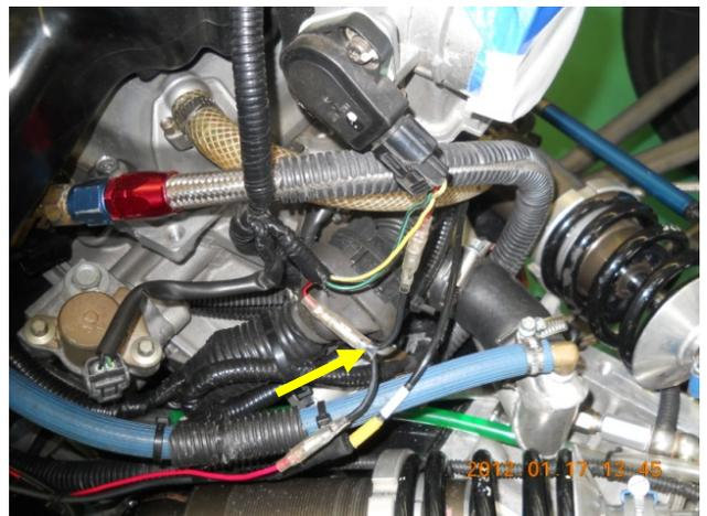
図10. スロットル・ポジション・センサ分岐
