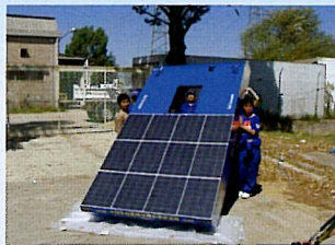
1日目の夜間走行が影響しエネルギーが不足。休憩中は少しでも多くエネルギーを回収。太陽光の入射角が90度になるように傾け中。
